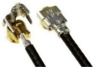
I-PEX 微型射頻同軸連接器 ( MHF® ) 系列採用的 **i-Fit®無焊端接技術** 消除了由焊料引起的射頻電纜組件電氣性能變化，並保持了均勻的電氣特性。
