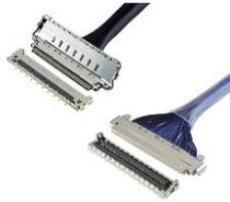
**CABLIN®**是使用極細同軸電纜的連接器系列，可在各種裝置內部以佔用空間最小化的方式傳輸高速訊號。它支援高速度傳輸協議，例如 64 Gbps/lane、PAM4、USB4、Thunderbolt 3、eDP HBR3 和 PCIe Gen 3/4。
