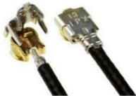
I-PEX 微型射頻同軸連接器 (MHF®) 系列採用的 **i-Fit® 無焊端接技術** 消除了由焊料引起的射頻電纜組件電氣性能變化，並保持了均勻的電氣特性。
