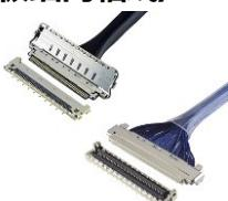
**CABLINE®** 连接器系列使用极细同轴电缆，可以在各种设备内部以节省空间的方式传输高速信号。它支持 64 Gbps/lane PAM4、USB4、Thunderbolt 3、eDP HBR3 和 PCIe Gen 3/4 等高速传输。
