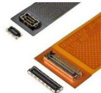
**NOVASTACK®**は高速伝送に対応した基板対基板(FPC)コネクタシリーズです。USB4(20 Gbps/lane)、5G ミリ波、サブ 6、eDP HBR3 などの高速伝送・高周波規格に対応します。
