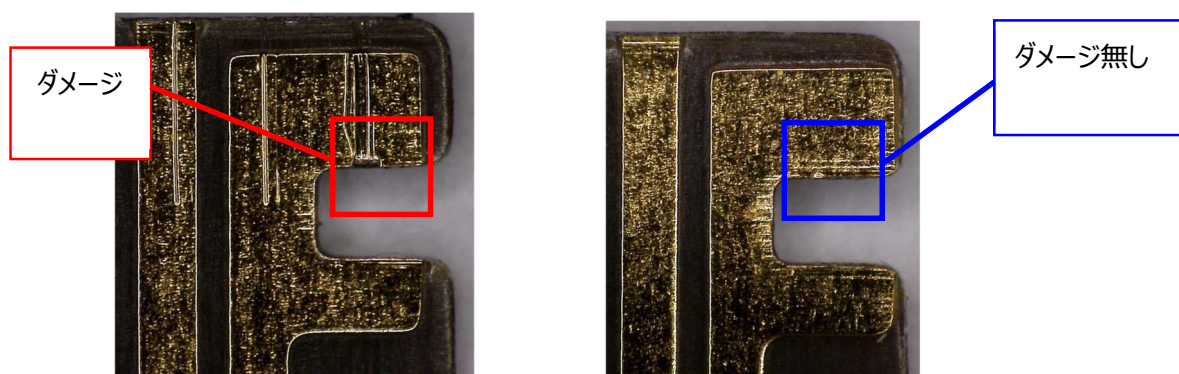
図 23.(a) アクチュエータークローズ状態で抜去した場合 (b) 正常抜去した場合
