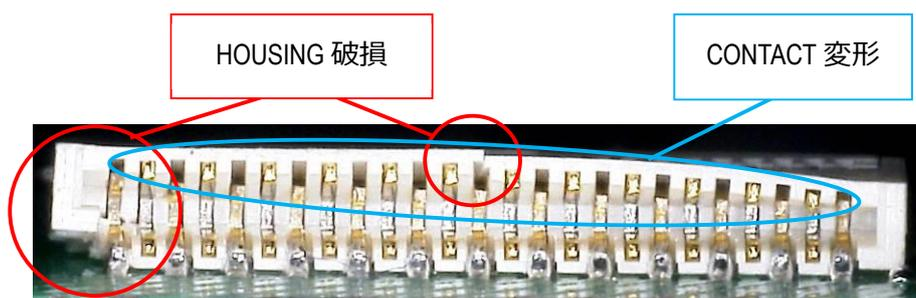
写真 7. HOUSING 破損及び CONTACT の変形 (NG)
