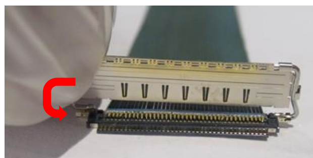
图片 12 锁杆配件组装
